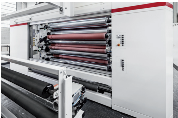
在 Prepack 的工厂部署的 W&H 5L MDO 生产线
