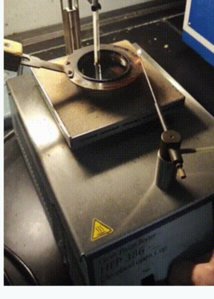
基于ASTM D92开口杯法测闪点
