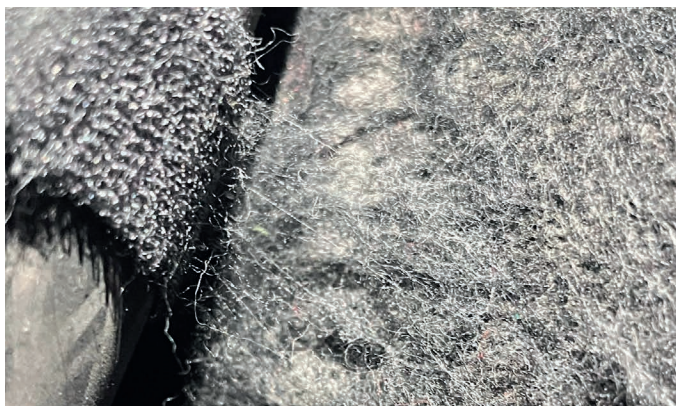
图 1：使用魔术贴造成的汽车地板磨损
