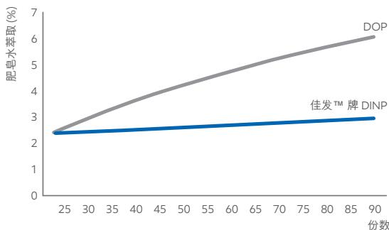
COPCO<sup>SM</sup> 模拟：肥皂水萃取，基于 ASTM D1239 配方：S-PVC 100 份，DOP 或 DINP 25-95 份，碳酸钙 60 份。
