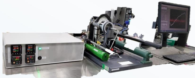
高压粘度计已实现半自动化，提高操作精度。
