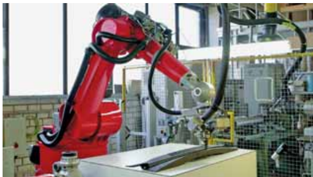
机器人在 2013 福特 C-MAX@HEV 汽车的发动机罩通风帽（简称“CVG”）上直接挤出管状的型材密封
